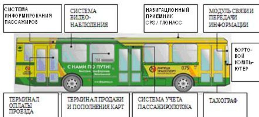
Рис. 2. Бортовой программно-технический комплекс [2]
